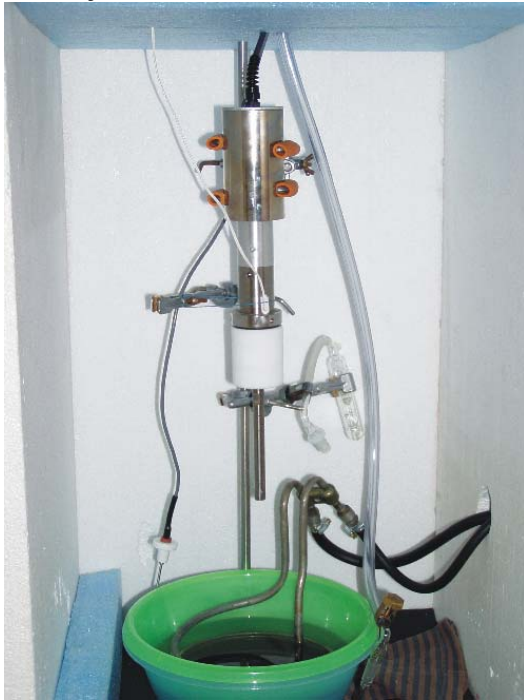
Obr. 4 Sonifikátor bez reakční baňky
